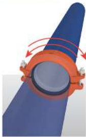
2.5 นำข้อต่อ Coupling มาประกอบพร้อมขันนอตสลับซ้าย-ขวา ซ้าย-ขวา จนแน่น
