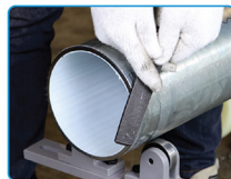
การตะไบลบคมขอบผิวท่อเหล็ก
