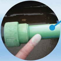
ท่อพลาสติกกรอบ และเปราะ เมื่อใช้งานกลางแจ้ง
